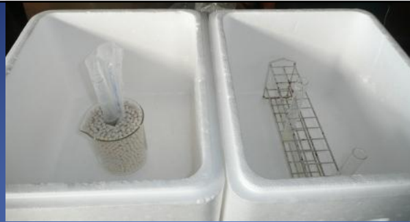
左: モナザイトで照射中(約15 \mu Sv/h) 右: コントロール 発泡スチロールの蓋を閉めて放置する
